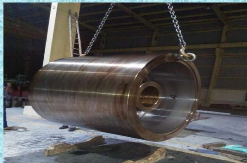
Rotor Hub(Dia.2.0m, H-1.9m)
