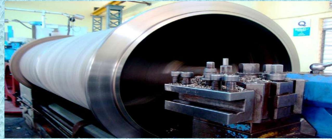
Turning Vane (Dia. 1.2m, L-3.4m)
